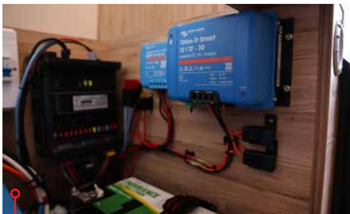
DC/DC-laddaren från Victron Energy övervakar generatorns laddning.
