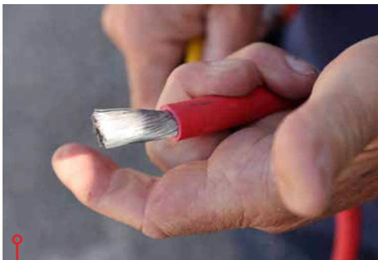
Hela arbetet är kvalitetssäkrat. YPS använder förtennad kabel för bästa effekt.
