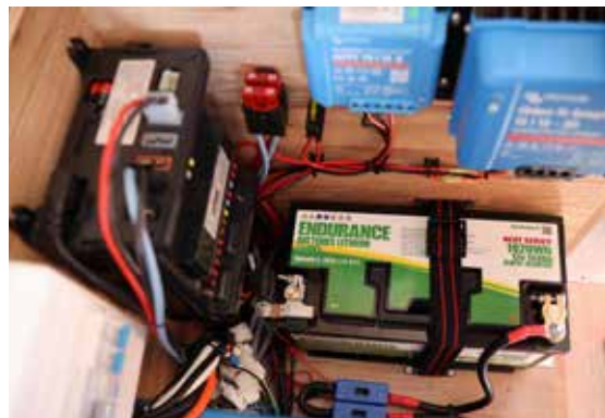
DC/DC-laddaren från Victron Energy övervakar generatorns laddning.
